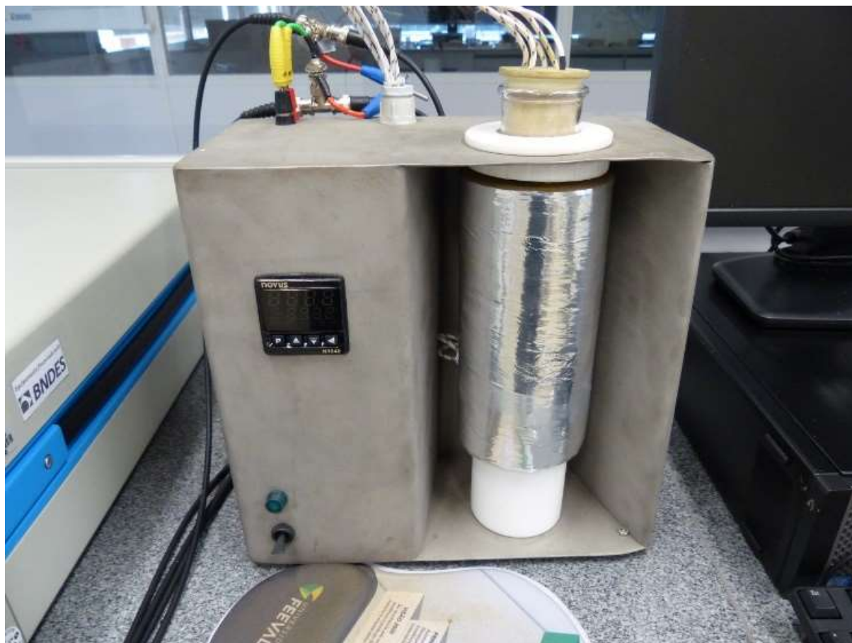
Figura 3. Célula para medida de condutividade, vista do dispositivo completo.
