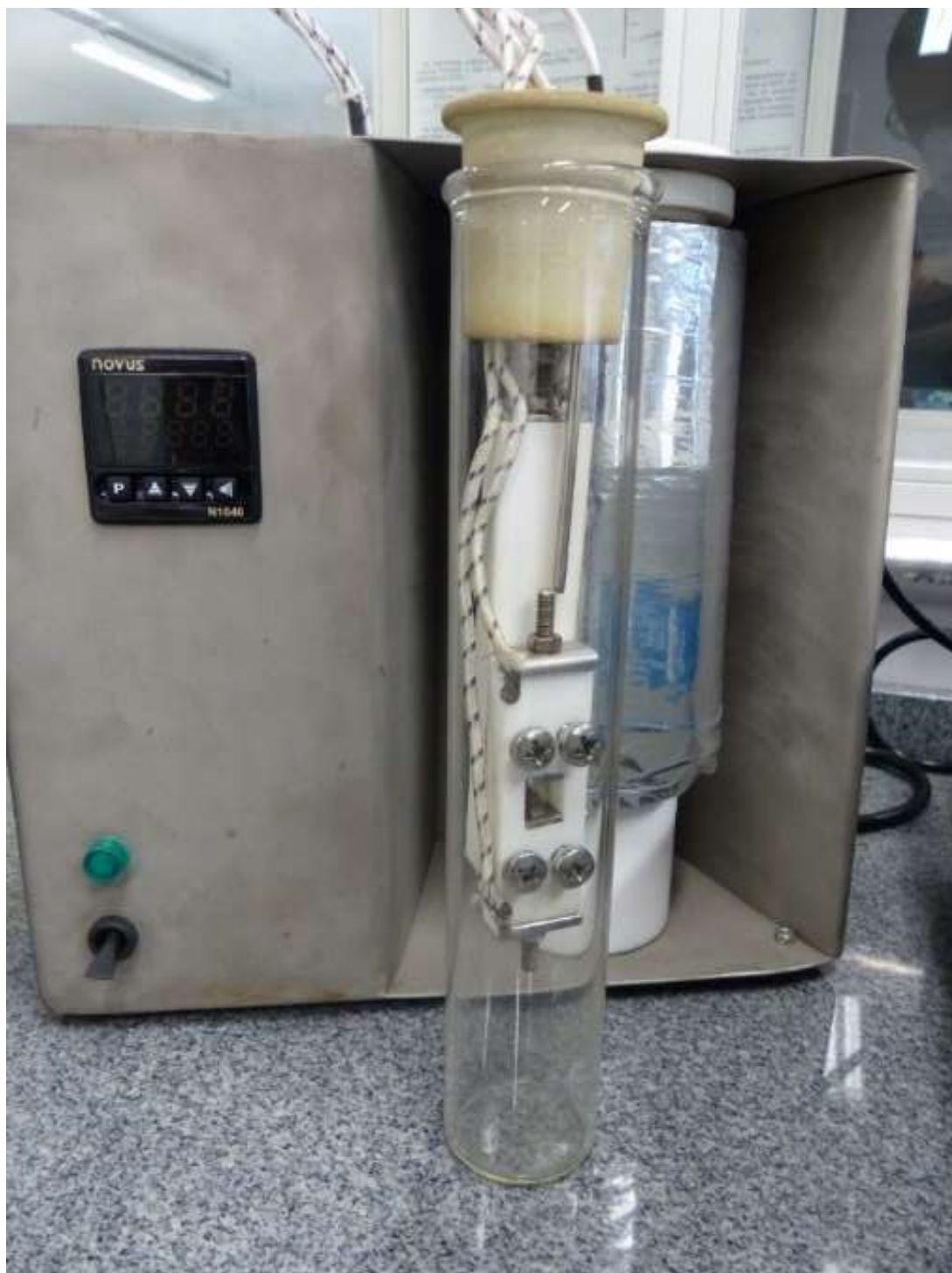
Figura 2. Célula para medida de condutividade, vista do conjunto contendo eletrodos entre placas de Teflon®, inseridos no tubo de vidro.
